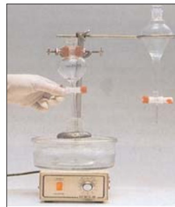
Figure 2. Obtention de l'éthanoate de butyle.
