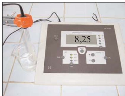
Mesure du pH de la solution d'éthanoate de sodium 5 \cdot 10^{-3} M.
