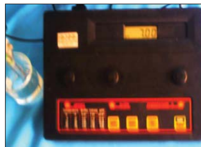
Figure 3. Mesure du pH de l'eau distillée.
