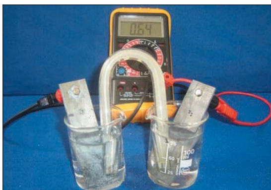
a) Mesure de la f.é.m. de la pile ( P_a ) avant dilution.
