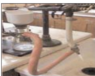
Figure 3. Filtration avec un dispositif Büchner.
