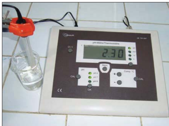
Figure 2. pH d'une solution de chlorure d'hydrogène 5.10^{-3} M.
