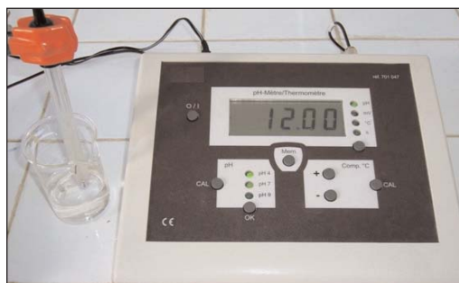
Figure 4. Mesure du pH d'une solution aqueuse d'hydroxyde de sodium.
