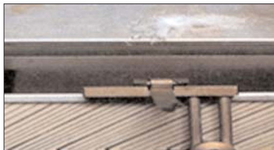
Figure 6. Banc Kofler pour la détermination de la température de fusion.
