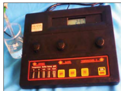
Figure 4. Mesure du pH d'une solution d'acide éthanóique.
