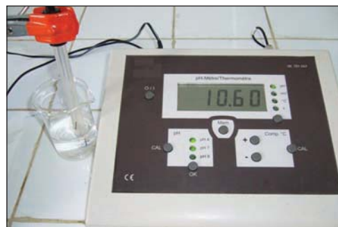
Figure 5. Mesure du pH d'une solution aqueuse d'ammoniac.
