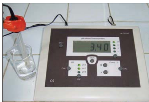
Figure 2. Mesure du pH d'une solution aqueuse d'acide éthanóique.
